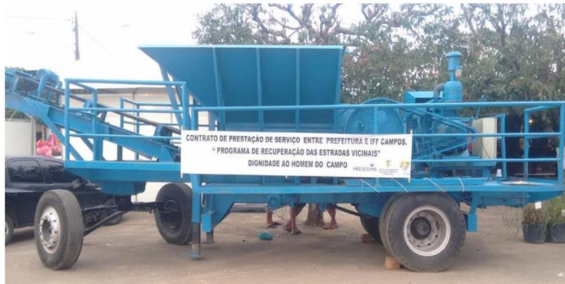
Figura 54. Britador para entulhos de obras descartados em Miracema/RJ.
