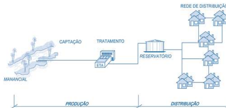
Figura 26. Esquema simplificado de um sistema de abastecimento. Fonte: Relatório Anual de Informações aos Usuários - Miracema (CEDAE, 2018)
