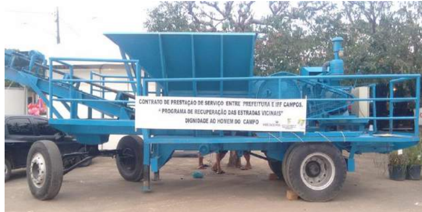
Figura 54. Britador para entulhos de obras descartados em Miracema/RJ. Fonte: Facebook Coopcrem, 2019.
